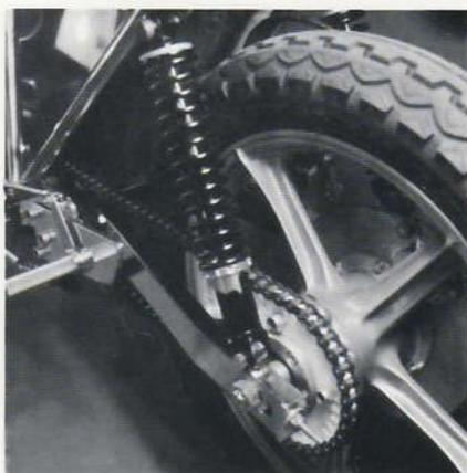
Spezial-Kusterschwinge, kegelrollengelagert und für Originalrahmen passend.
